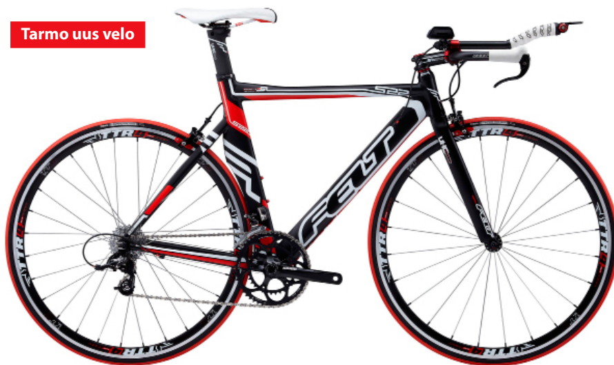
Triatloniratas Felt S22 (alumiiniumraam, karbonhark, Sram 500 käiguvahetus, kaal 9,45 kg). Hind A&T Spordis 1595 eurot.
